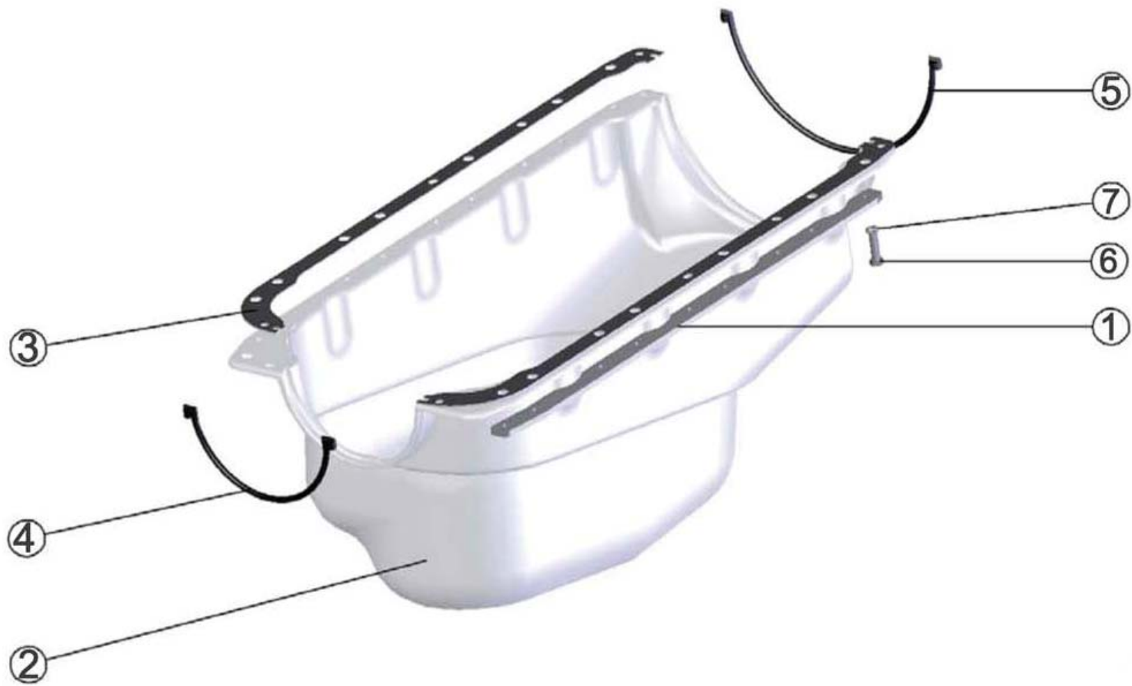
Рис. 7 Установка картера масляного Fig. 7 Oil case installation
