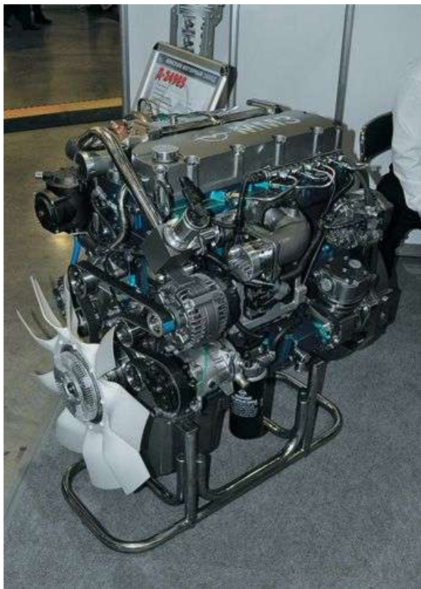
Д-249 — первый минский дизель, сразу спроектированный для автомобиля, хотя ограничений в его применении не будет
