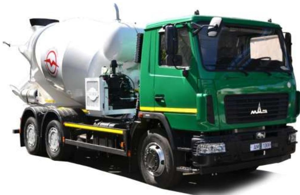
Предназначен для принятия, транспортирования с перемешиванием в пути следования и выгрузки бетонной смеси в место укладки.
