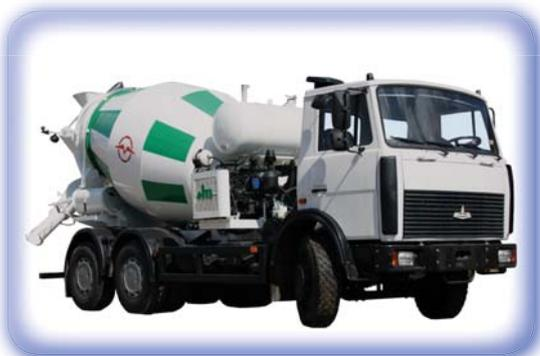
Автобетоносмесители МАБС производства Минского моторного завода представляют собой реверсивные бетоносмесители установленные на надежном и экономичном шасси МАЗ 630342, -6303А3, -6303А5 и предназначены для транспортировки бетонной смеси, перемешивания ее в пути и разгрузки непосредственно на место укладки, или перекладки в другие бетонотранспортные устройства: бетононасосы, конвейеры, тару и т.п.
