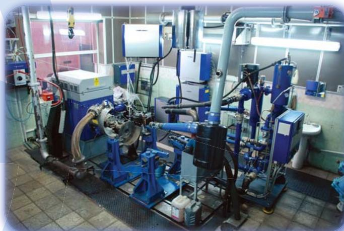
Испытательный стенд с системой автоматизации PUMA, AVL,
